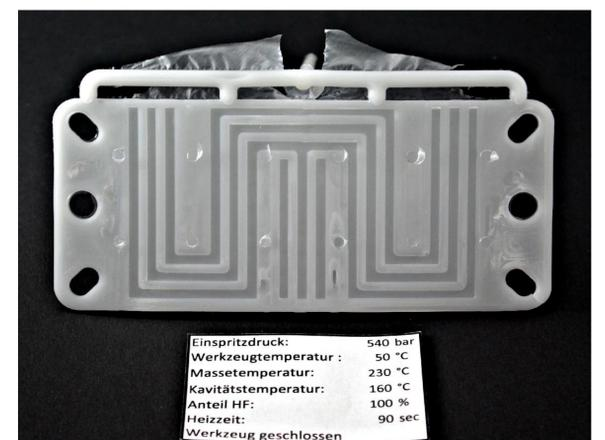
Abb. 6: Testplatte mit Induktion
