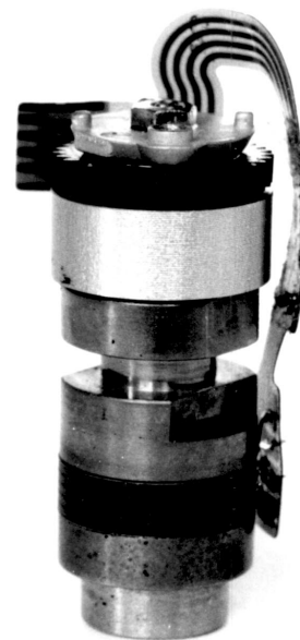
Abb. 6: Stabförmiger Wanderwellenmotor aus einem Objektiv von Canon
