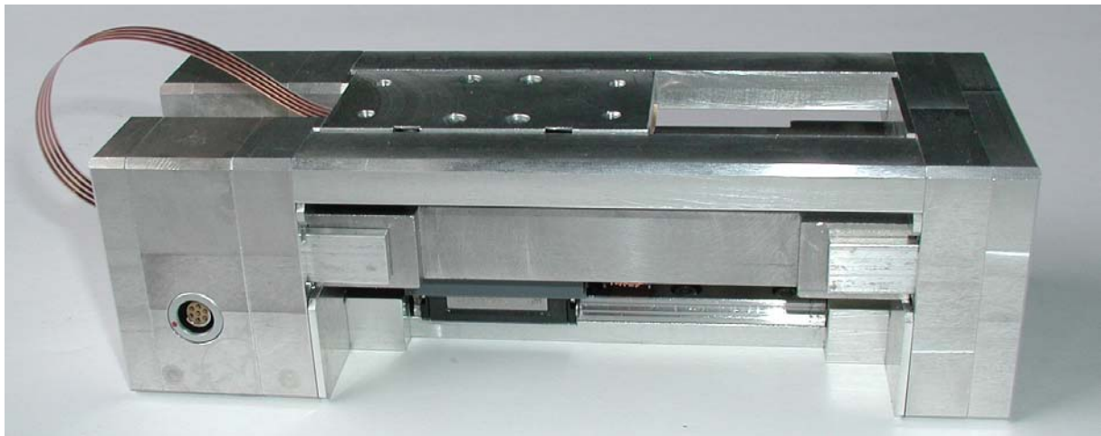
Bild 17: Einsträngiger, homopolarer Antrieb in Kastenspulenbauweise [5]
