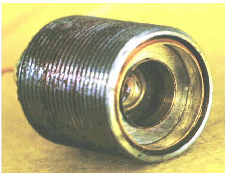
Bild 1 Fokussierantrieb für eine Endoskopoptik, Durchmesser 7 mm
