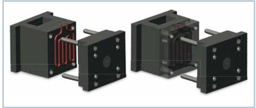
Bild 1. Je nach Anforderung empfiehlt sich eine externe (links) oder interne (rechts) Anordnung des Induktors (© IKFF)
