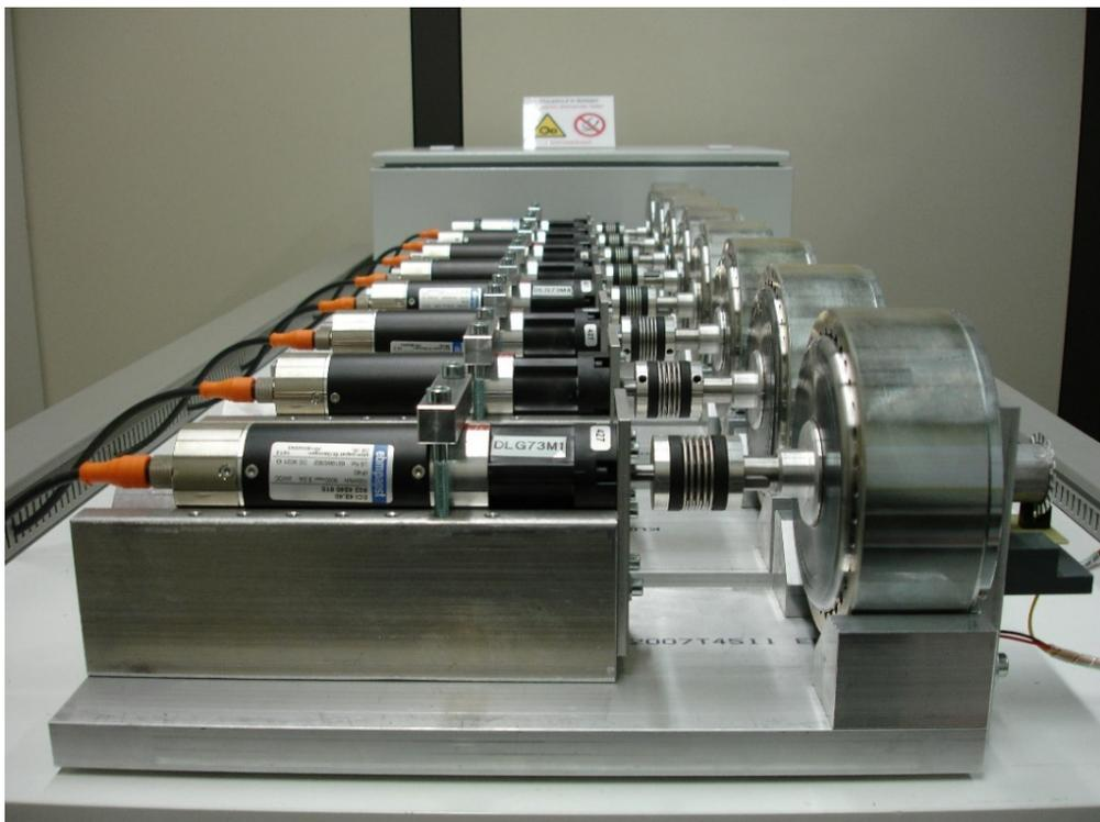
Abb. 51: Getriebe-Prüfplätze /44/
