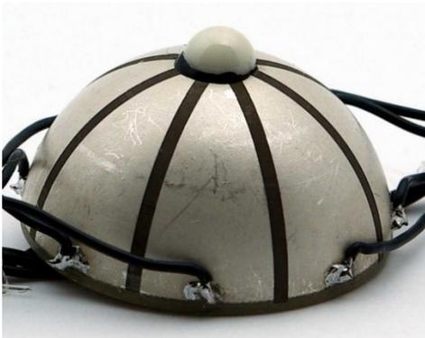
Abb. 34: Resonator eines Mehrkoordinatenantriebes mit piezoelektrisch erregter Halbkugelschalen-Geometrie /47/
