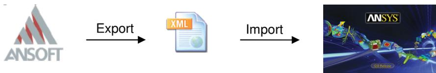
Fig.5: Kopplung von MAXWELL nach ANSYS
