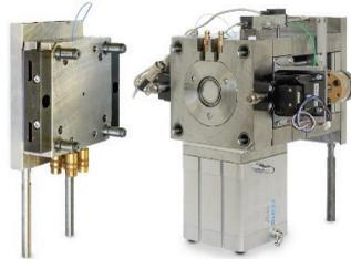
Neuartiges Messwerkzeug zur Ermittlung von adhäsionsbedingten Zugkräften beim Spritzgießen
