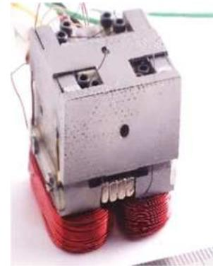
Prototyp eines MSM-gesteuerten Reluktanzaktors
