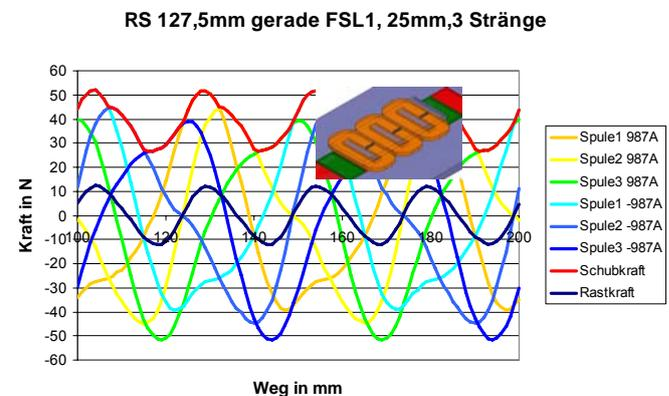
**Bild 4** Schub- und Rastkraftverlauf des nicht optimierten Flachspulläufers
