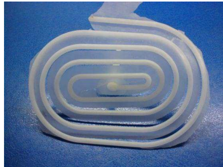
Fließwegverlängerung: 25 mm bei 100°C isotherm 920 mm bei 250°C variotherm (komplett gefüllt)
