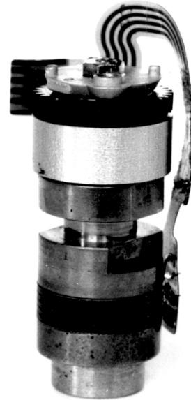
**Bild 8:** Stabförmiger Wanderwellenmotor aus einem Objektiv von Canon
